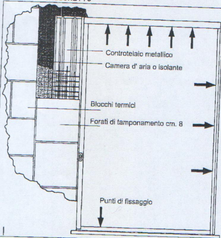
Introdurre il cassonetto sul lato muro, tamponare con forati da cm. 8 e finire a pareggio muro con intonaco (vedi fig. 1;2;3).
