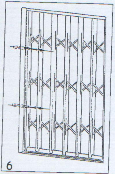
Solamente dopo aver verificato il perfetto funzionamento dell'inferriata, inserire dal lato dell'impacchettamento gli appositi perni antimanomissione nell'incavo della vite e chiudere con i tappi in dotazione (vedi fig. 6).
