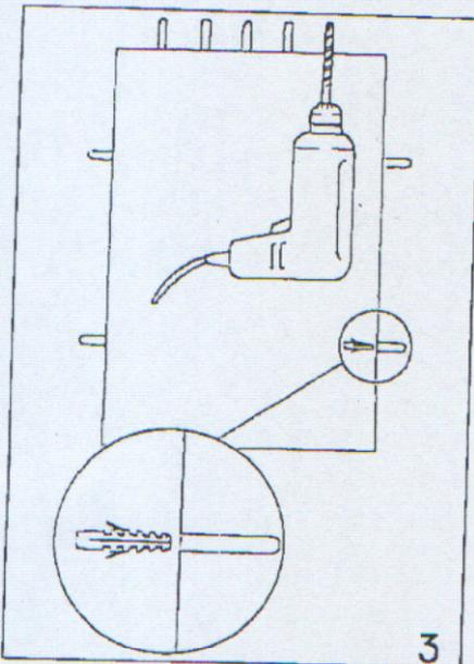
Forare nei punti precedentemente segnati con punte  $\varnothing 7$  mm (superiormente) e  $\varnothing 10$  mm (lateralmente) ed inserire i tappi di espansione in dotazione. (vedi fig. 3).
